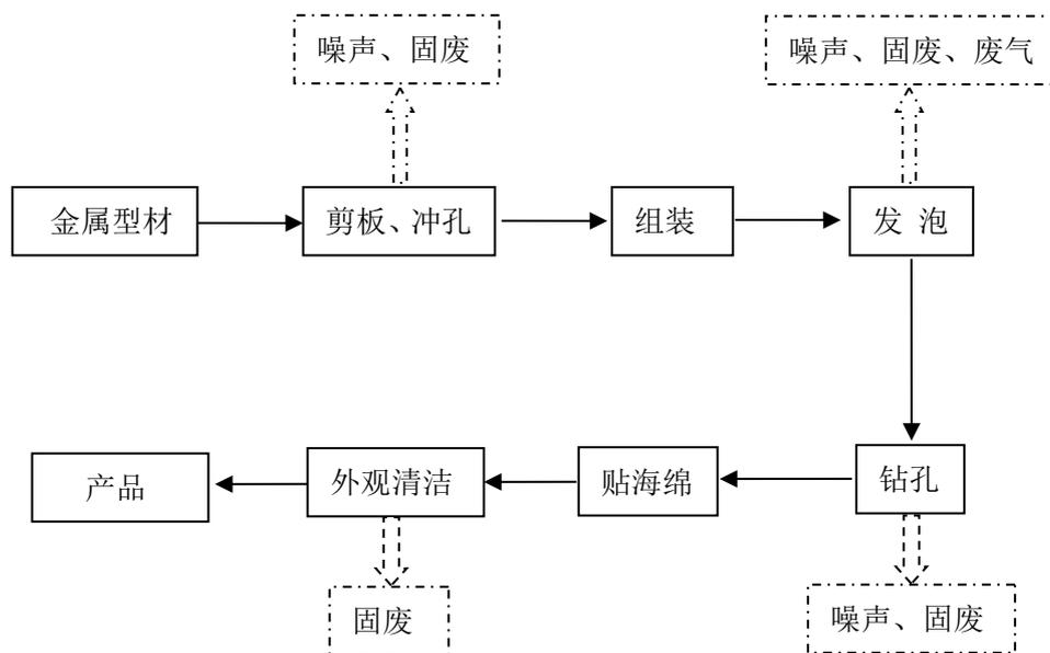
图 2.6-1 生产工艺流程图
