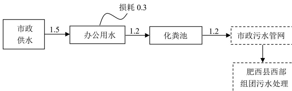
图 2.4-1 水平衡示意图 (单位: t/d)
